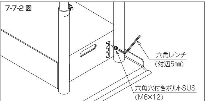
7-7-3 あがりかまち床面とベース設置面との中間程度になるように箱部の高さを調整し、六角レンチ（対辺 5mm）で六角穴付きボルト SUS(M6 × 12) を締め付けてください。
