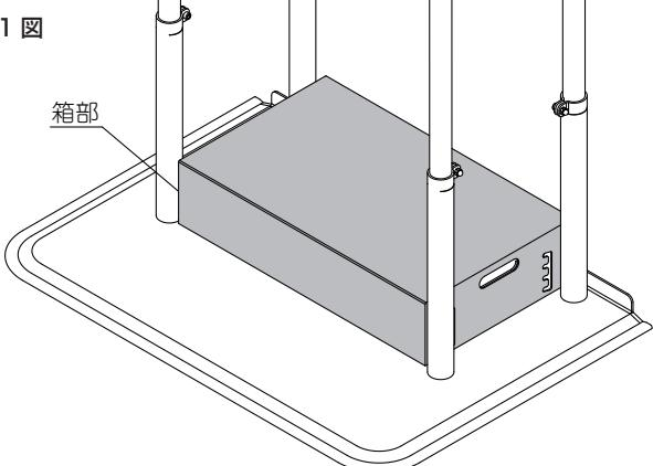
7-7-2 箱部の側面へ六角穴付きボルト SUS(M6 × 12) を取り付け、ボルトを半分程度まで回し込んでください。
