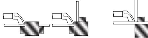
① 横ズレ防止用の壁取付用ビスφ 4.0×40 を壁に対し垂直に打ち込む。
