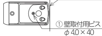
※ φ 4.0×40 打ち込み位置には下地がありませんが、このビスにより φ 4.0×70 を打ち込む際の横ズレ、壁・柱への食い込みを防止することができます。
