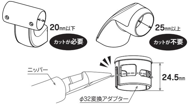
カットはアダプターの細く加工されている箇所(●印)で行う。
