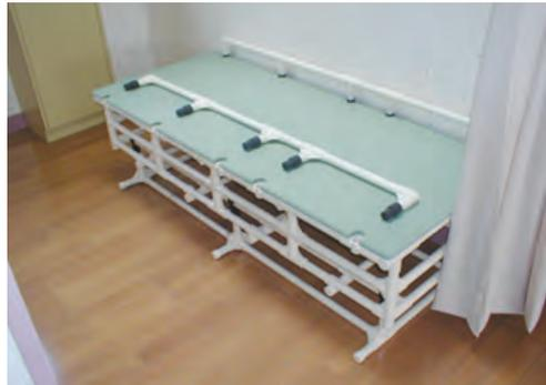
脱衣しやすい・介助しやすい高さで脱衣台を製作しました。取り外し可能な転落防止柵を取付けました。
