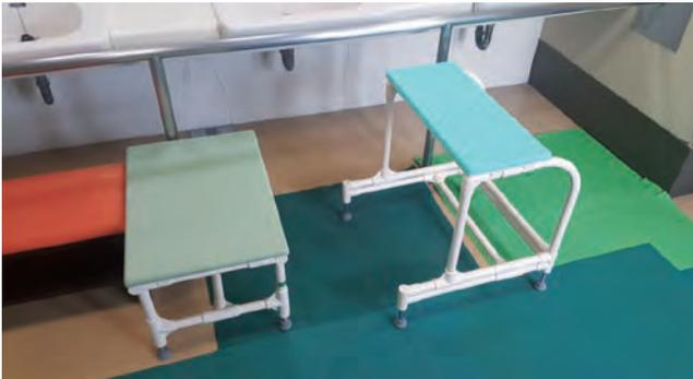
移乗して脱衣ができるように脱衣台(写真左)を製作しました。立ち上がりには前受けテーブル(P.10 参照)を使用しています。
