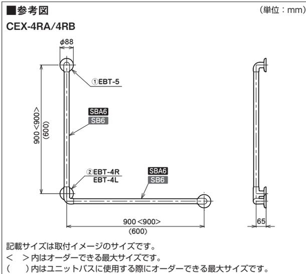
●材質・手すり: エラストマー樹脂被覆ステンレスパイプ/AAS樹脂被覆ステンレスパイプ
