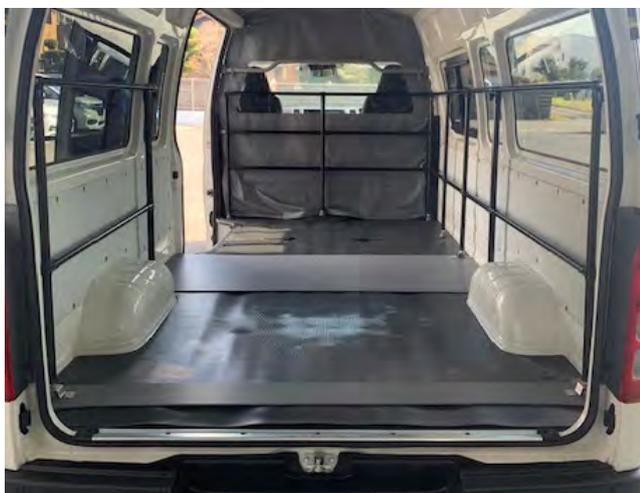
45-50-05 介護ベッドなどの積み込みをする際に、フレームに結束し、荷物の転倒・落下を防ぎます。
