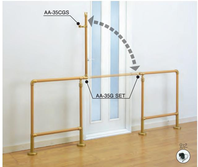
通路や扉の前など、手すりが途切れてしまう部分をはね上げ手すりにするだけで、動線上に連続した横手すりを構築することができます。さらに、はね上げ縦受けブラケットを使用すれば、はね上げた手すりが縦手すりになり、扉を開ける際の支えとして使用できます。ロック後はロックカバーを取り付けてください。
