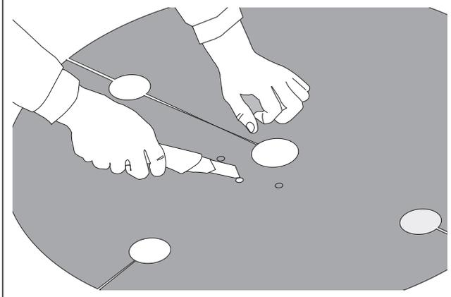
**手順 4** マットをベースに取り付け、マット中央部の円形に切り取った部分に樹脂円盤、カラーを入れ、上から膝当てを乗せて、ツマミで締め付けて仮固定します。
