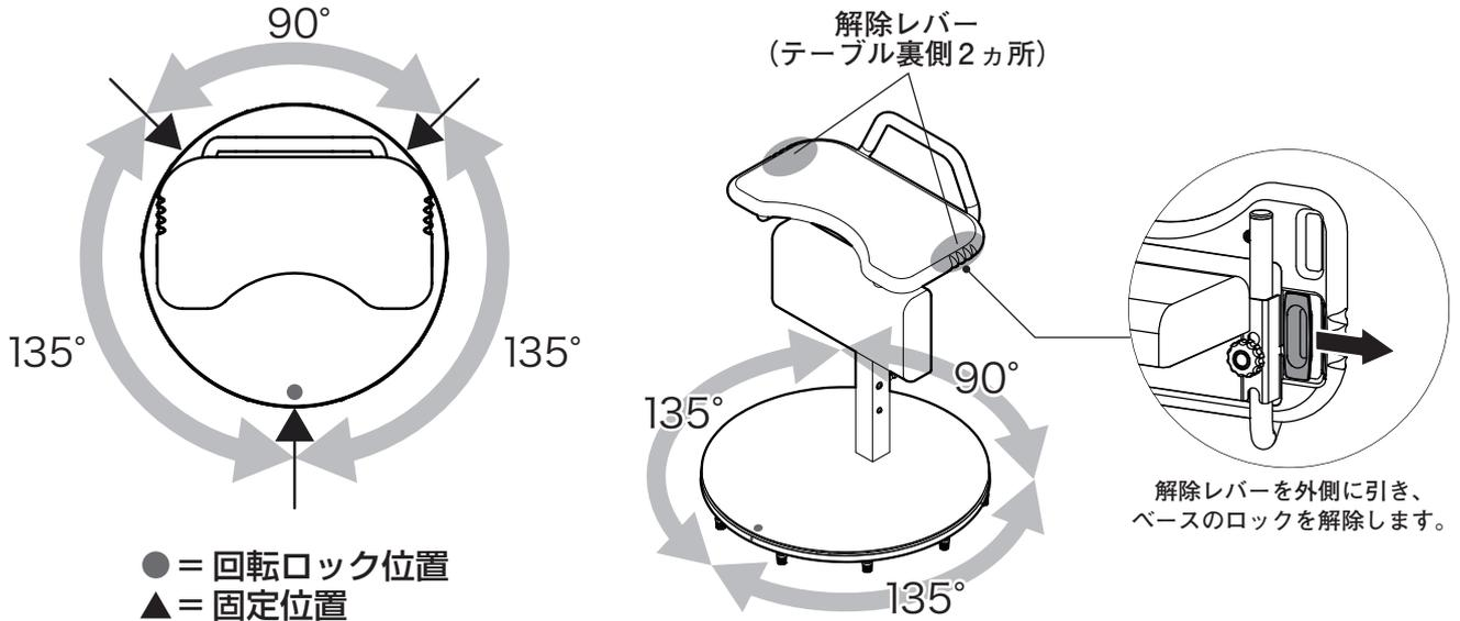
ベース「上面」及び「側面」には、回転がロックされる位置を示す目印として、ステッカーが貼られています。回転がロックされる位置の目印にしてください。
