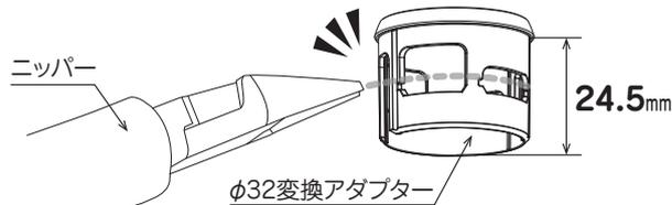
カットはアダプターの細く加工されている箇所 (●印) で行う。
