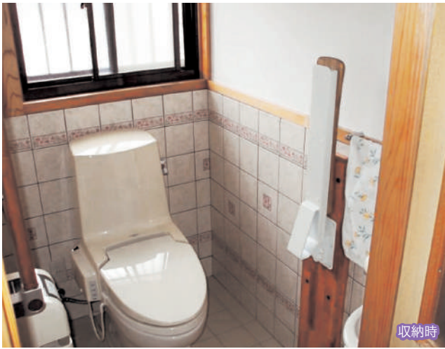
前受けタイプの可動式手すりです。(CFA-8) 使用しない場合は縦に収納できるので邪魔になりません。
