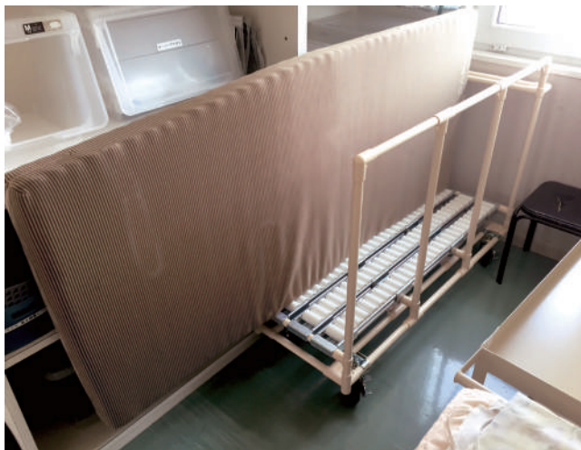
05-52-01 マット運搬台車で運搬が楽になり、使用しないマットは台車上で管理ができます。
