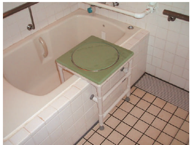
浴そうのまたぎを座りながら行う、座位入浴ができるようにターンテーブル付の入浴台を製作しました。 25-41-06
