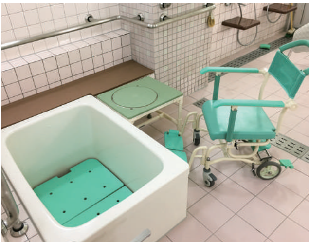
シャワーキャリーで移動し、ターンテーブル付き入浴台で移乗、浴そう内を底上げし、安全に入浴できるようにしました。 27-41-03
