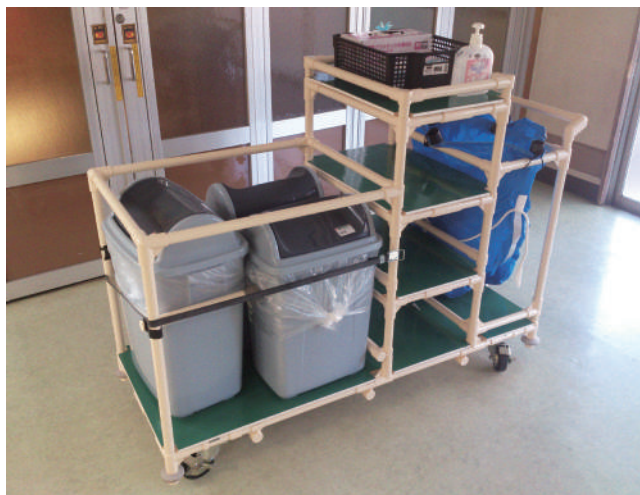
27-52-04 一度に大量に搬送できる台車を設計しました。ゴミ箱は持ち上げず、取り出しやすくしています。
