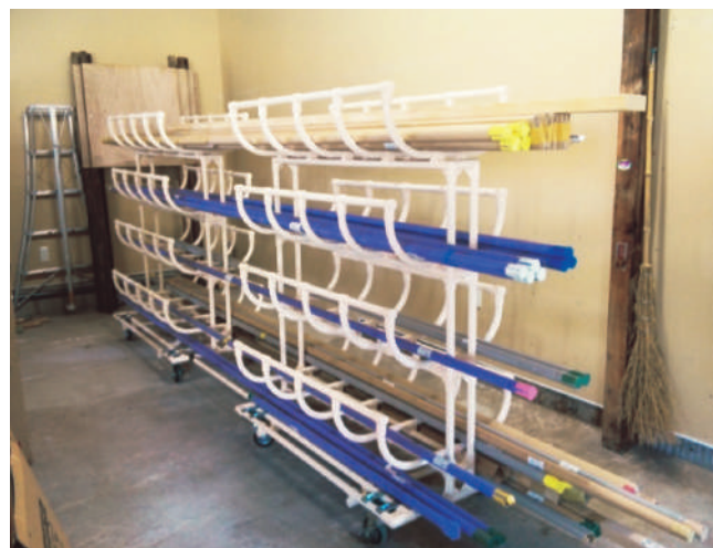
51-54-02 手すり棒等の長尺物を在庫する台車です。数の管理や持ち出しがしやすくなります。
