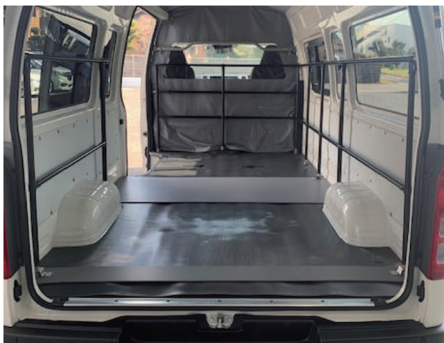
45-54-05 介護ベッドなどの積み込みをする際に、フレームに結束し、荷物の転倒・落下を防ぎます。
