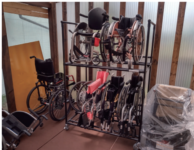
05-52-02 使用しない時の車いすを一時保管する専用台車です。一度に移動させることができます。
