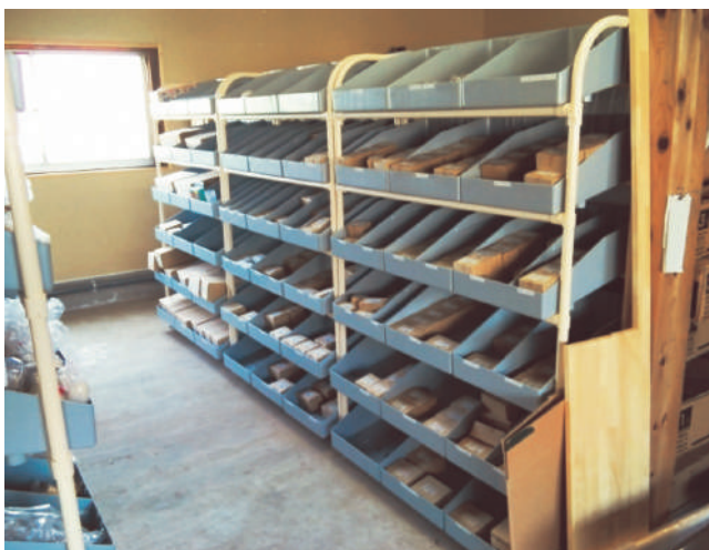
51-54-01 管理が大変な手すり部材等を、数の管理、持ち出しをしやすいするために管理棚を製作しました。
