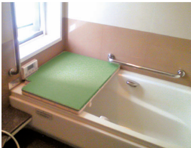
27-06-03 既製のバスボードでは姿勢が安定しないご利用者様に合わせて奥行を大きくしたバスボードを製作しました。
