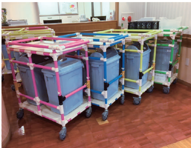
47-52-03 カラーパイプを使用してユニット単位で使い分けられるようにした台車です。
