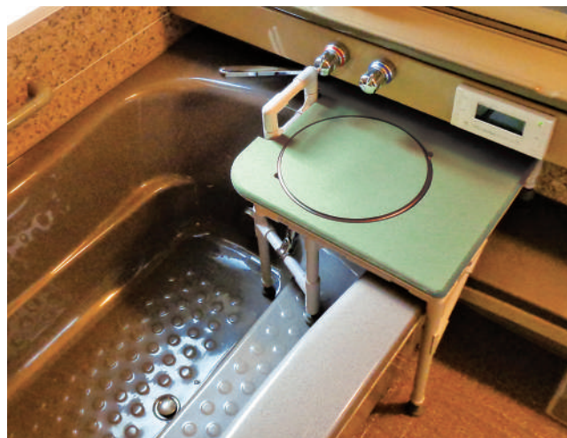
27-06-04 浴そうに浸かれる部分を極力確保し、座位入浴ができるような入浴台を製作しました。
