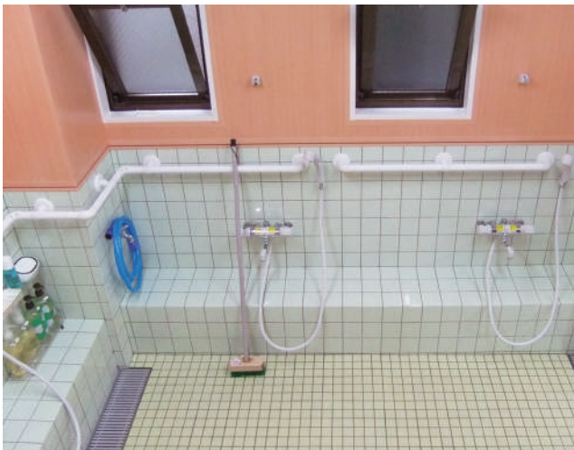
シャワー前の立ち上がり補助と洗い場内の移動を補助する手すりです。 61-33-03
