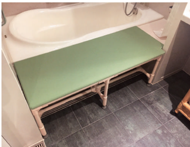
11-42-01 ホテルの浴室で車いすを使用するご利用者が移乗しやすきように入浴台を製作しました。
