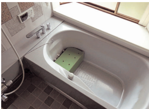
長い浴そうで脚がつかばれない方が、安心して入浴できるように浴そう内いすの前面にマットを取り付けました。27-07-03
