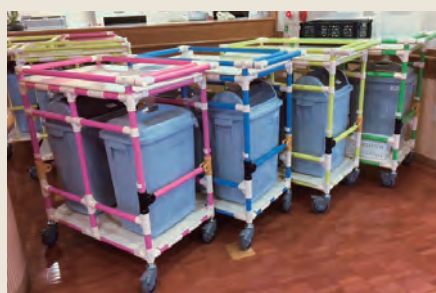
ダストボックスが2個載るおむつ交換台車 パイプの色分けで使用場所の区別が分かりやすくなります。
