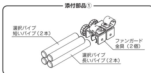
3. 六角レンチ (5mm) を使用してボルトをゆるめ、選択したイレクターパイプ2本を右図のように通してボルトを締めます。
