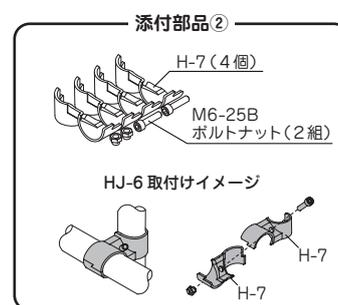
ファンガードフレームの中央位置目印を車椅子の中央に合わせて、左右の水平およびイレクターパイプの出っ張りやメタルジョイント (HJ-6) の位置が左右均等になっているかを確認してから六角レンチ (5mm) でボルトを締め付けてください。車椅子のキャスターがファンガードフレームに当たらないかを確認してください。
