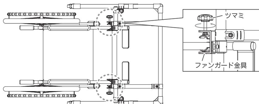
2. 矢印の方向（車椅子フレームを外側、ファンガード金具を内側）に軽く引っ張りながらファンガードを車椅子フレームから引き抜きます。
