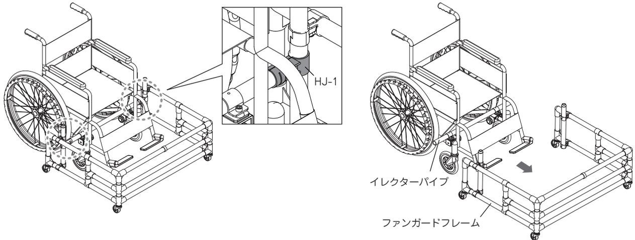
2. 六角レンチ (5mm) を使ってどちらか一方のイレクターパイプを固定しているボルトをゆるめ、両側のファンガード金具のツマミを回してクランプ部を広げます。ボルトをゆるめた方のファンガード金具を外し、反対側のファンガード金具も外して引き抜きます。
