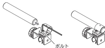
4. ファンガード金具のツマミを回してクランプ部を広げ、クランプ部を車椅子のレッグパイプにはさんで固定します。
